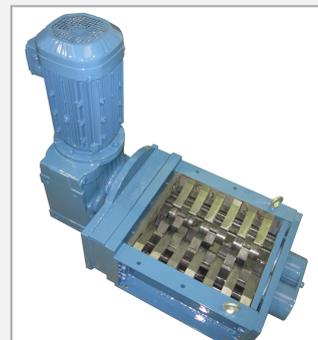
Il trituratore è caratterizzato da una serie di coltelli montati su due alberi paralleli con senso di rotazione opposto.
