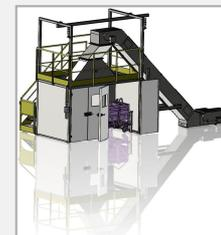
Raccolta dei trucioli, separazione dei pezzi e dei trucioli, frantumazione, ciclo di centrifugazione automatico, stoccaggio, compattazione
