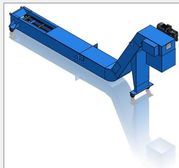
I trasportatori a draga vengono utilizzati per il trasporto di trucioli corti, polveri o fanghi (ghisa, alluminio o ottone). La miscela di liquidi e trucioli cade nella draga e si deposita sul fondo, i trucioli vengono recuperati mediante raschiatori e versati in una benna. Le diverse catene su cui sono fissati i raschiatori di diversa altezza hanno passo 40, 42 o 65
