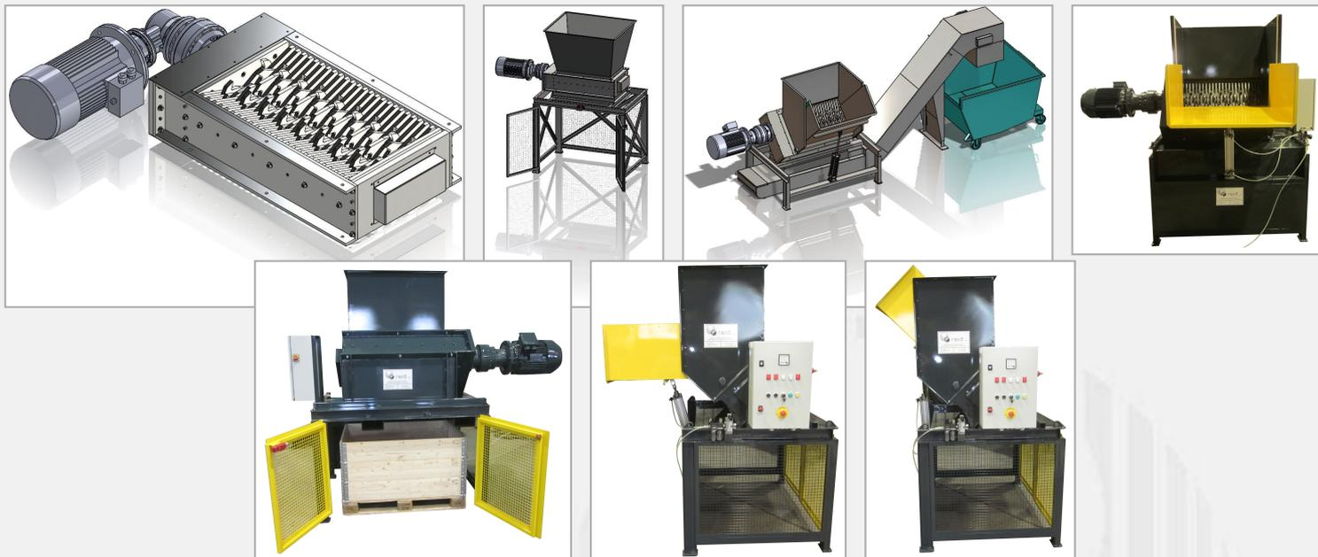
Il trituratore è caratterizzato da una serie di coltelli montati su due alberi paralleli con senso di rotazione opposto.
