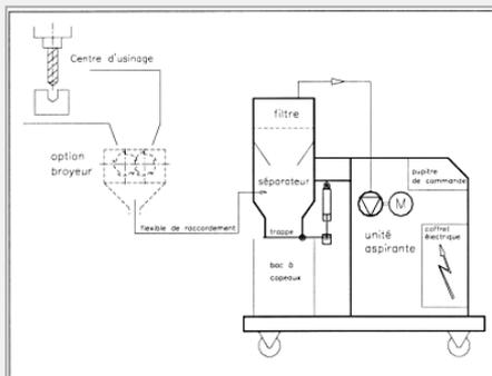
La gamma di unità di aspirazione OMSAT è specificamente adattata all'estrazione di trucioli o particelle fini (metallo, plastica, polvere, ecc.) e utilizza tecniche affidabili e semplici da implementare. Ciascuna unità può essere utilizzata da sola o collegata a una rete di vuoto centralizzata e vi sono numerose opzioni per configurare le nostre macchine in modo da soddisfare i requisiti precisi di ciascuna applicazione.
